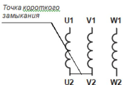
Переключатель S1 установлен в положении «ВКЛ», что означает моделирование короткого замыкания фазных обмоток U и V.
