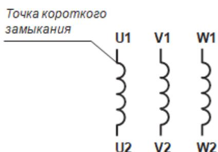
Переключатель S10 установлен в положении «ВКЛ», что означает моделирование короткого замыкания фазной обмотки U.
