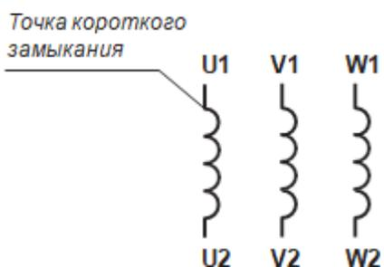
Способ обнаружения неисправности: подключите омметр (мультиметр) к двум клеммам обмотки, соответственно (а именно, U1 и U2), и измерьте сопротивление обмотки. Если измерительный прибор не показывает никакого значения сопротивления (0 Ом), то это подтверждает короткое замыкание.
